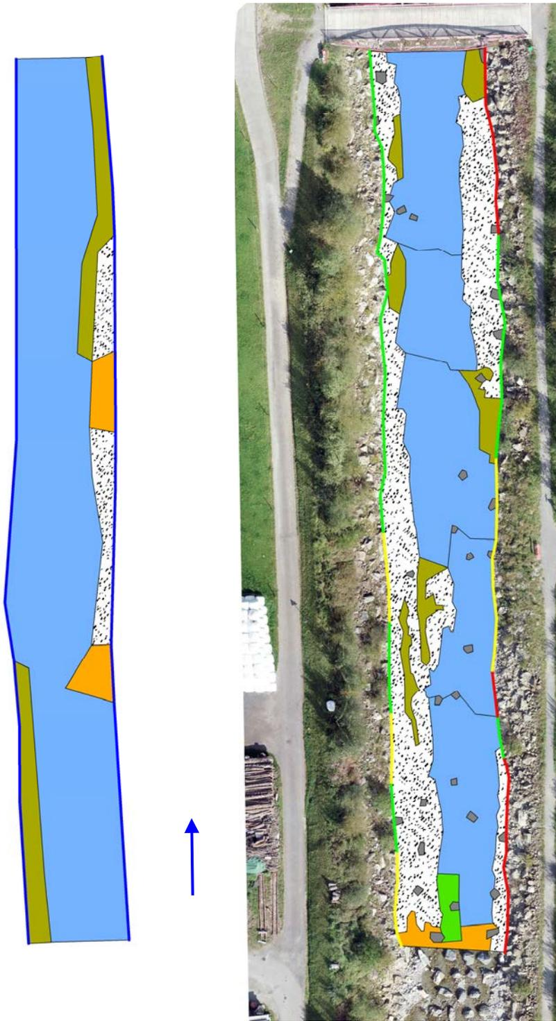
**Abb. 5.5: Uferbewuchs und Mesohabitate in der Strecke Stöcken** im Ausgangszustand am 11.11.2009 bei einem Mittelwasserabfluss von ca. 450 l/s sowie im Projektzustand am 9.10.2018 bei einem Niederwasserabfluss von ca. 250 l/s.
